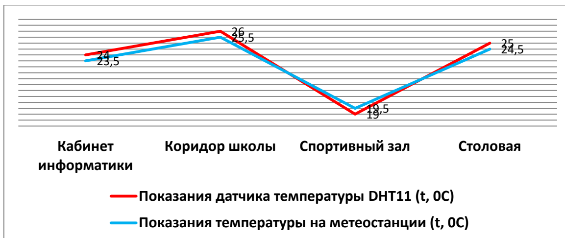
Рис. 1. Сравнительный анализ датчика температуры и сертифицированной метеостанции.
